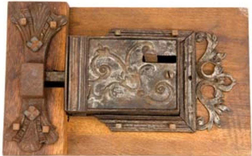
**Schlosskasten-Verriegelung für zweiflügeliges Tor (Standflügel)**
